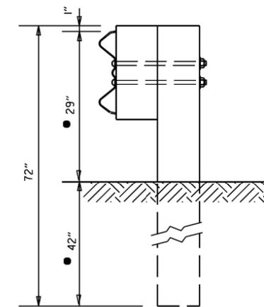
W-BEAM TO THRIE BEAM TRANSITION RAIL WITH WOOD OR PLASTIC BLOCKOUT & WOOD POST
