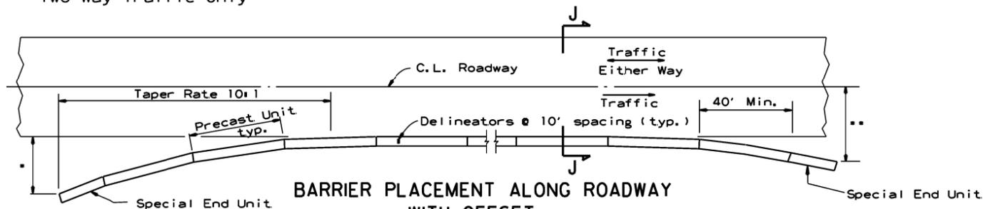
**BARRIER PLACEMENT ALONG ROADWAY WITH OFFSET**
