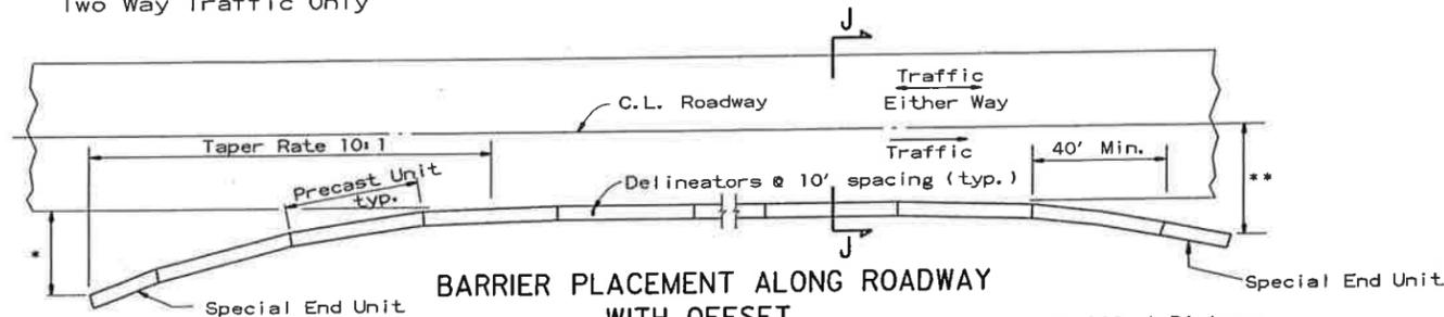
**BARRIER PLACEMENT ALONG ROADWAY WITH OFFSET**
