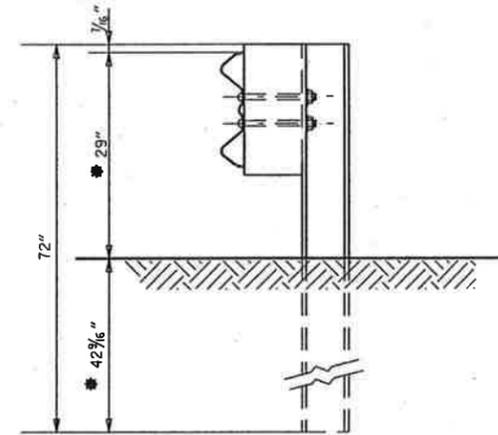
W-BEAM TO THRIE BEAM TRANSITION RAIL WITH WOOD OR PLASTIC BLOCKOUT AND STEEL POST
