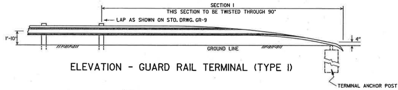
ELEVATION - GUARD RAIL TERMINAL (TYPE I)
