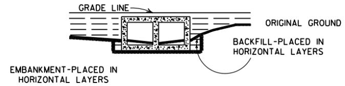
BACKFILL DETAILS FOR BOX CULVERT
